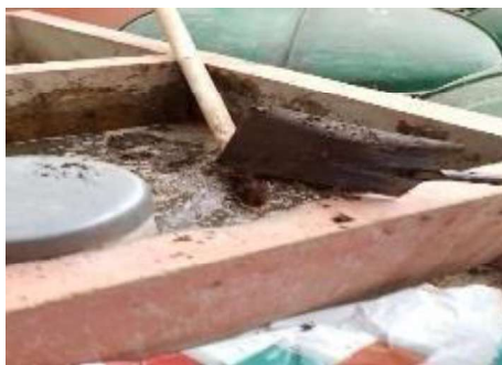
Gambar.7 Proses pencampuran limbah organik daun dan limbah organik kantin ke dalam bak penampung limbah, setelah diaduk kemudian limbah tersebut dimasukkan ke dalam tangki Biodigester.
