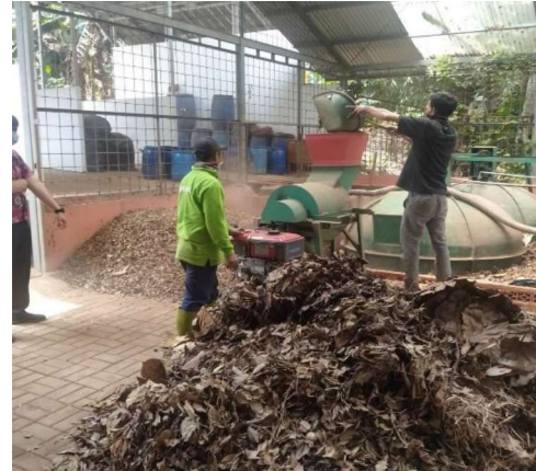
Gambar.4 Sampah daun/organik kantin dihaluskan menggunakan mesin pencacah
