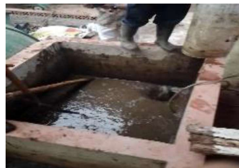
Gambar.7 Proses pencampuran limbah organik daun dan limbah organik kantin ke dalam bak penampung limbah, setelah diaduk kemudian limbah tersebut dimasukkan ke dalam tangki Biodigester.
