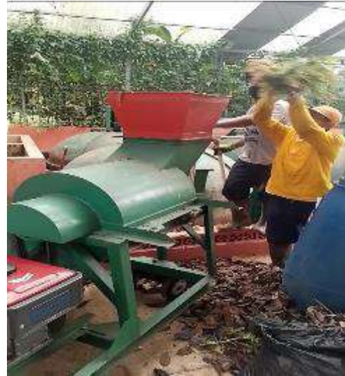
Gambar 4 Proses pencacahan limbah sayuran kantin
